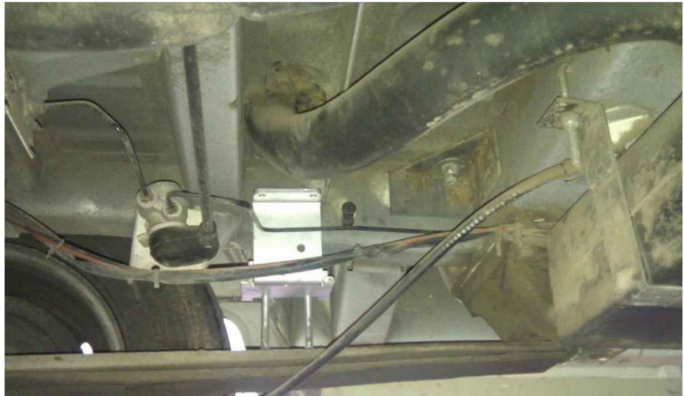
Sovitin on asetettava taka-akselin etupuolelle kuvan osoittamalla tavalla.
