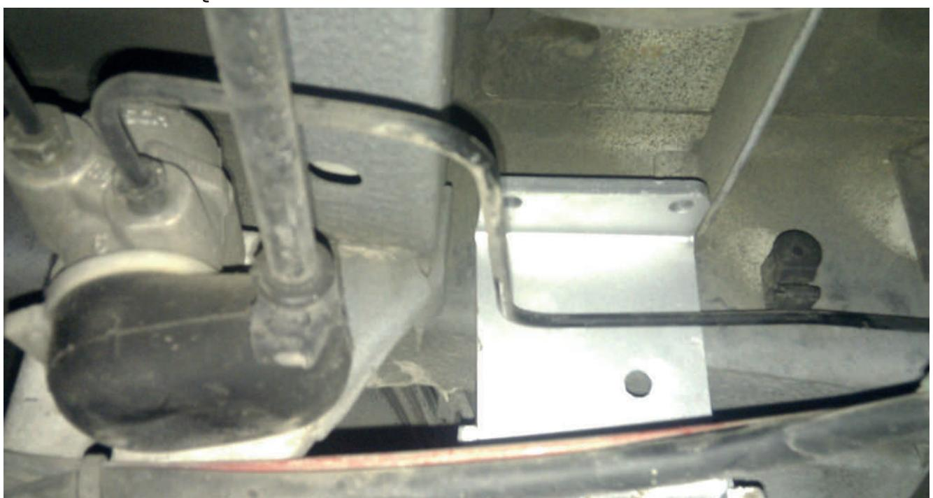
Inserte los adaptadores, luego perfore los agujeros de 10 mm (en ambos lados); finalmente inserte y fije la barra de conexión.
