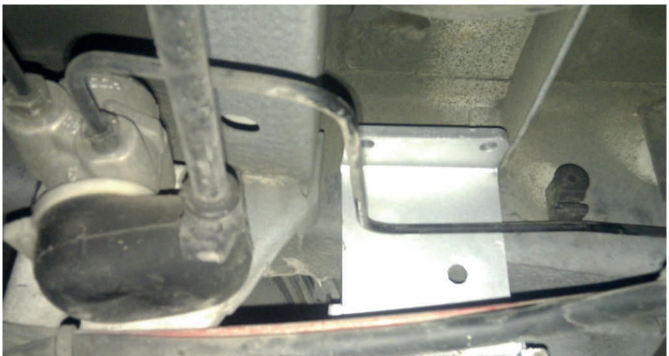
Insérer les adaptateurs, puis percer les trous de 10 mm (des deux côtés) ; enfin insérer et fixer la barre de connexion.
