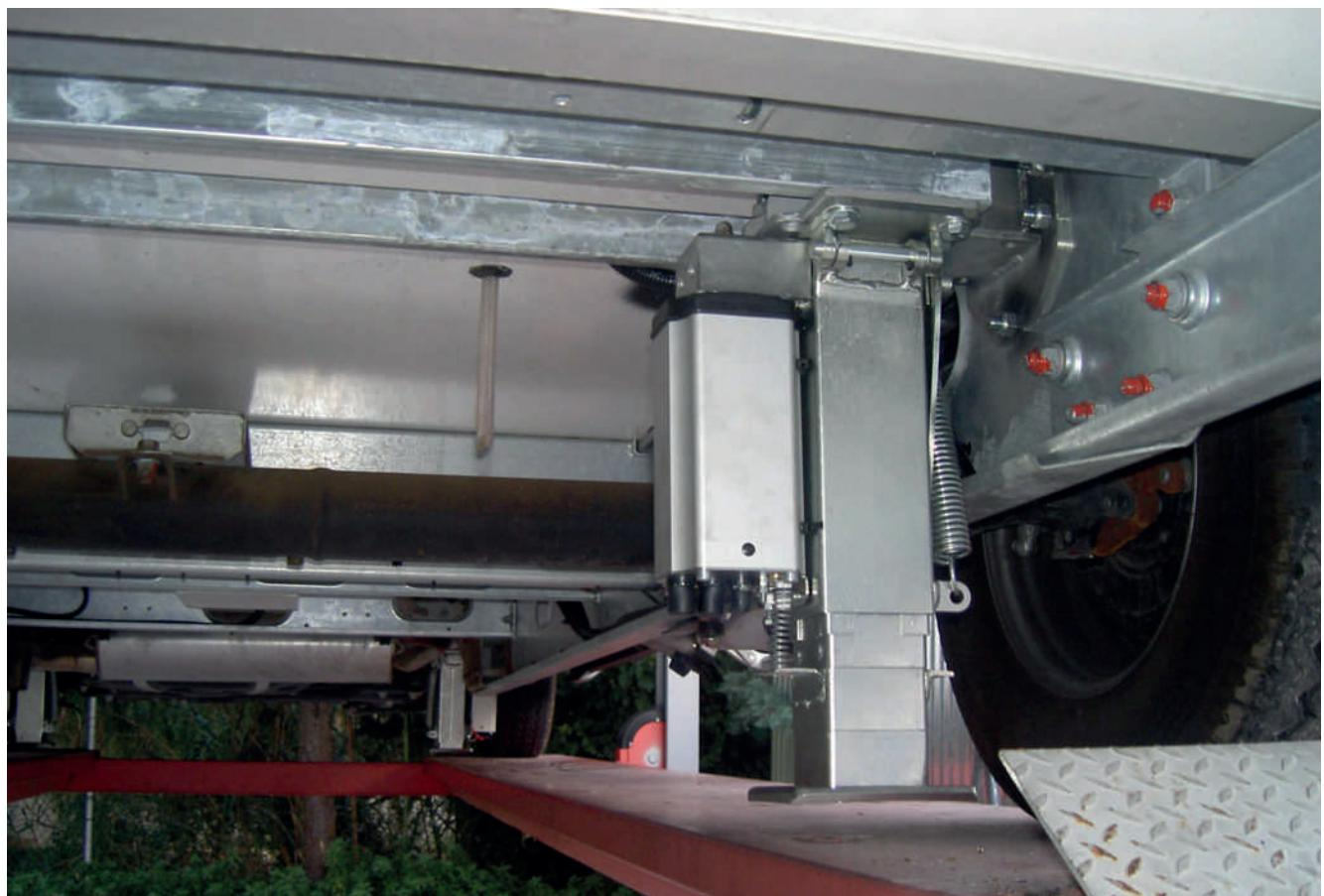
Achtung: beide Wagenheber müssen mit dem Motor nach hinten gerichtet sein, die Drehung zum Fahrzeuginneren.
