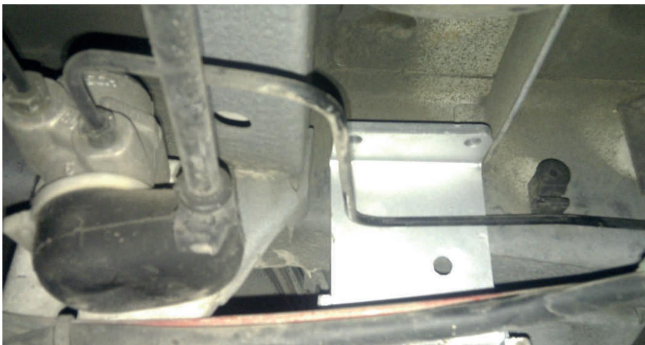
Indsæt adapterne, bor derefter de 10 mm huller (på begge sider); indsæt og fastgør til sidst forbindelsesstangen.
