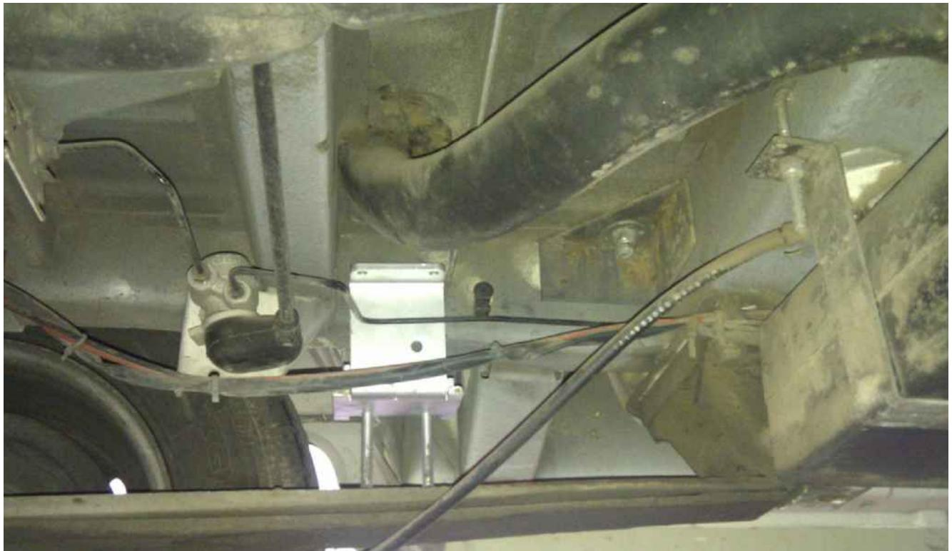
L'adaptateur doit être placé à l'avant de l'essieu arrière, comme indiqué sur la photo.
