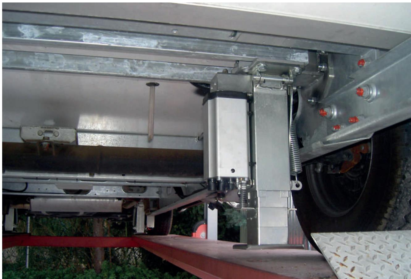
Atención: ambos gatos deben estar orientados con el motor hacia atrás, la rotación hacia el interior del vehículo.
