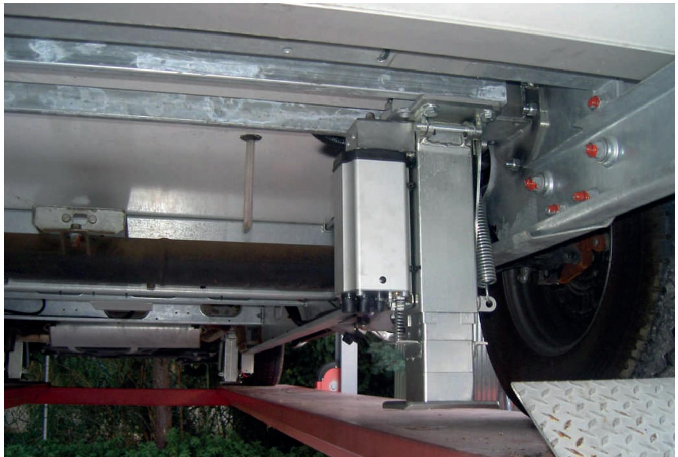
Se upp: båda domkrafterna måste vara vända med motorn mot baksidan, rotationen mot fordonets insida.
