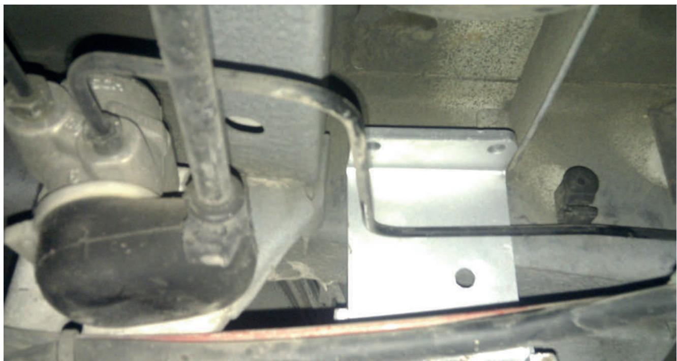
Die Adapter einsetzen, dann die 10-mm-Löcher (auf beiden Seiten) bohren; zum Schluss die Verbindungsstange einsetzen und befestigen.
