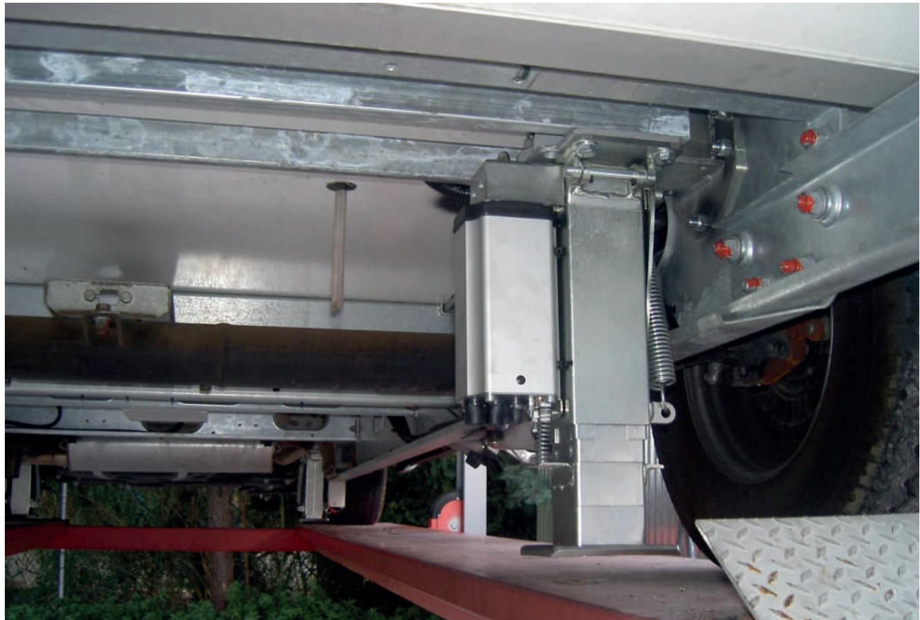
Opgelet: beide steunen moeten met de motor naar achteren gericht zijn, draaiing naar de binnenkant van het voertuig.
