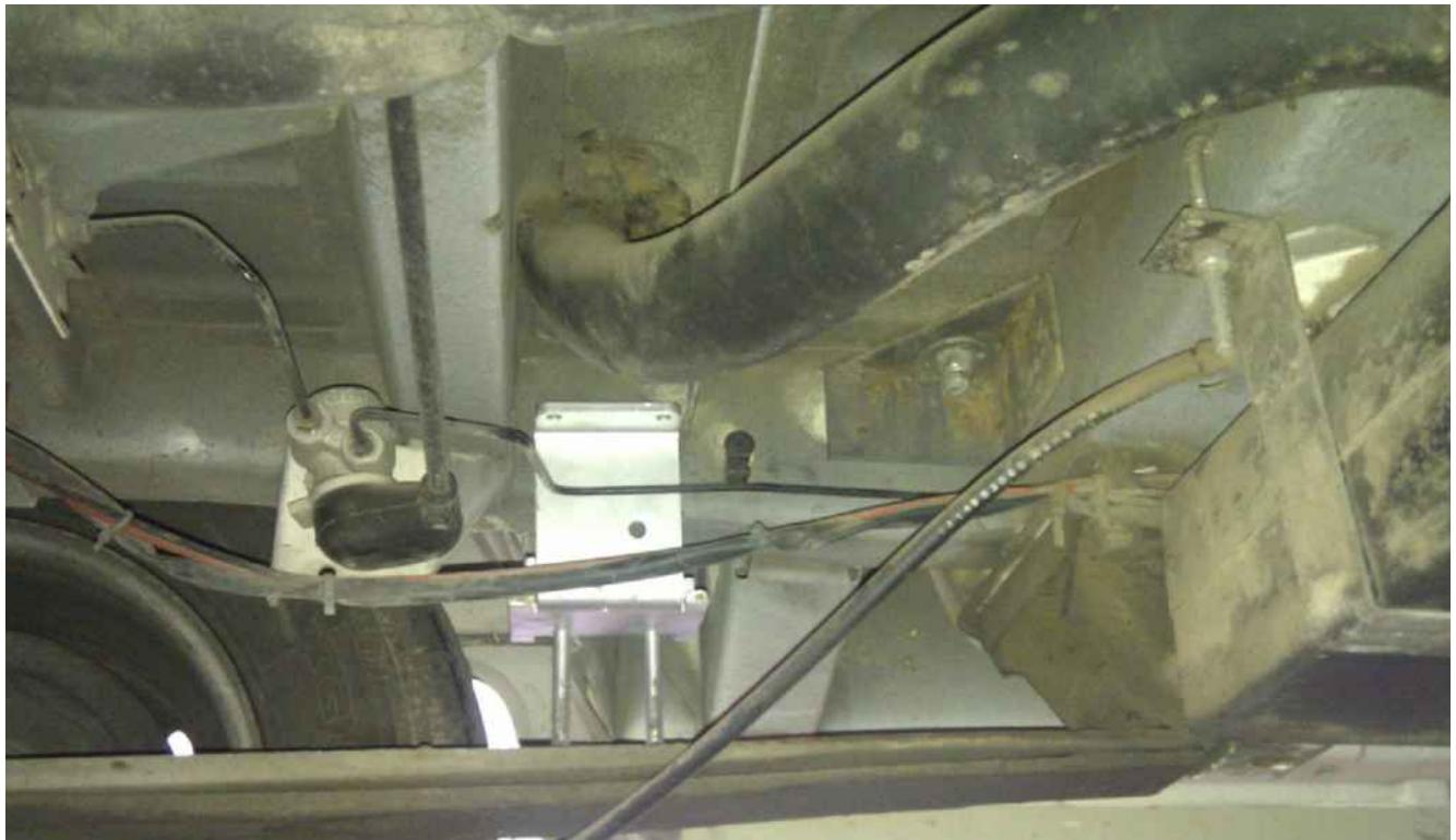
El adaptador debe colocarse en la parte delantera del eje trasero, como se muestra en la foto.
