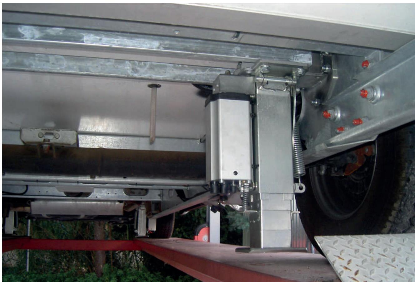
Attention : les deux crics doivent être orientés avec le moteur vers l'arrière, la rotation vers l'intérieur du véhicule.
