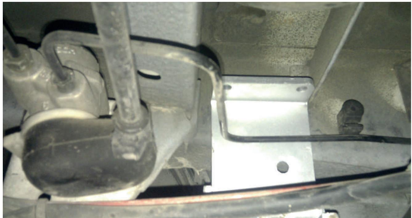
Aseta sovitimet paikalleen, poraa sitten 10 mm:n reiät (molemmin puolin); aseta lopuksi liitääntätanko paikalleen ja kiinnitä se.
